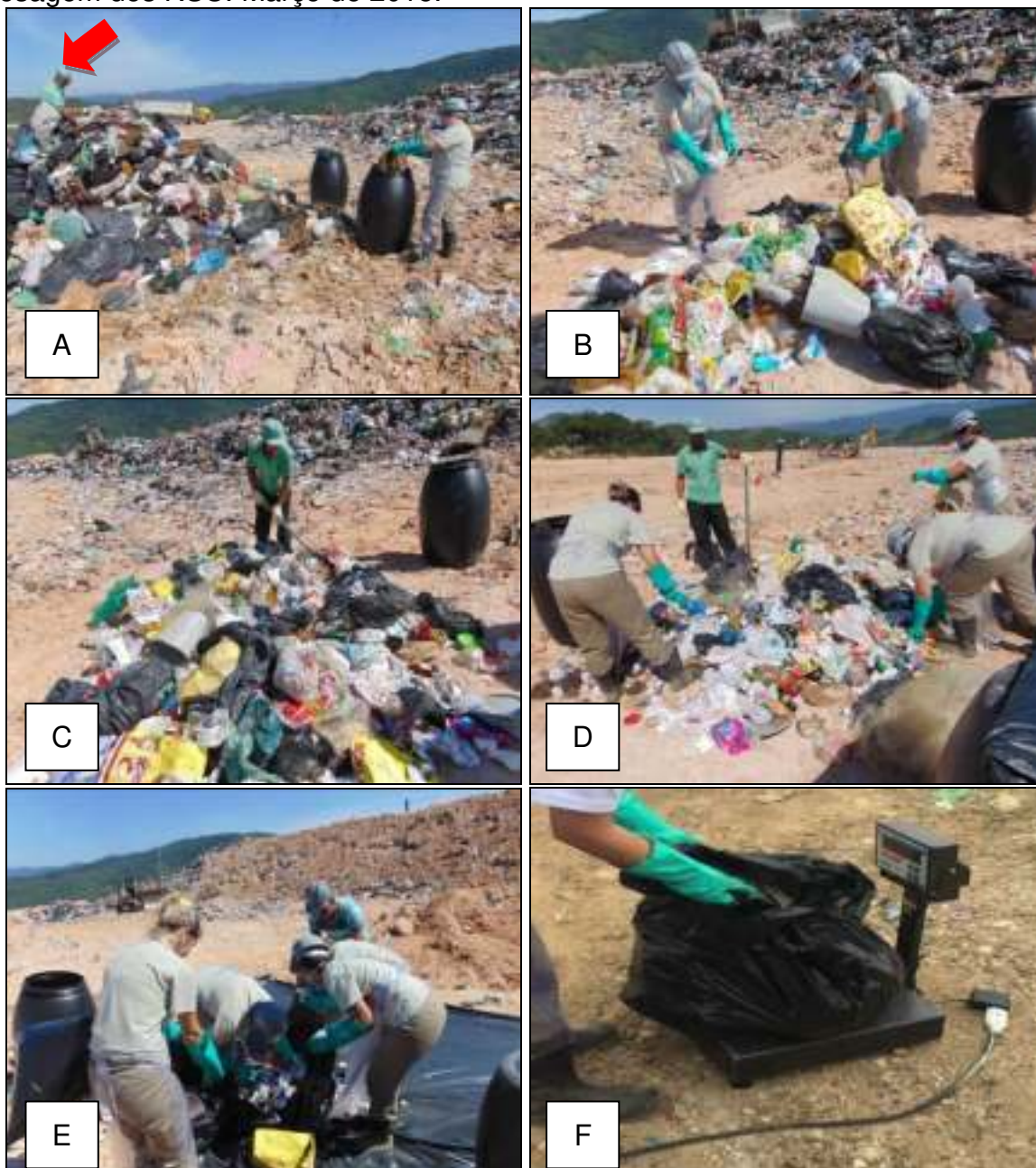
Figura 3 - A) Amostra retirada do topo da pilha; B) Rompimento das sacolas para homogeneização da amostra; C) Homogeneização da amostra através de revolvimento da pilha; D) Coleta dos dois quadrantes; E) Triagem dos resíduos; F) Pesagem dos RSU. Março de 2015.
